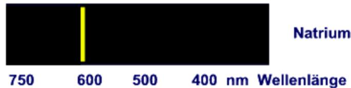
Abbildung 41: Spektrum einer Natriumdampflampe. Die Natrium-D-Linie besteht eigentlich aus zwei sehr nahe beieinanderliegenden Spektrallinien. (Fornoff 2011, Das Spektrum der Sonne)
