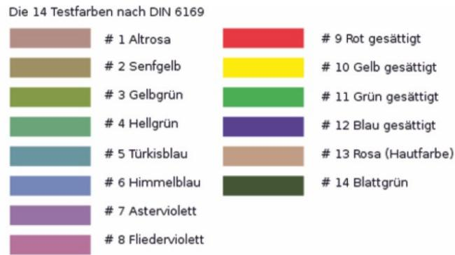
Abbildung 42: Testfarben zur Farbwiedergabe. Die ersten acht der 14 Testfarben wurden zur Bestimmung des  $R_a$ -Wertes herangezogen. Die Farben entsprechen der DIN 6169 (Deutsches Institut für Normung) (Lübbe 2013: 124)
