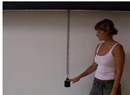
Abb. 7: Auslenkung des Pendels
