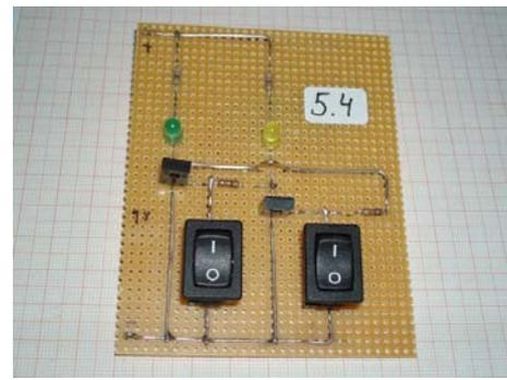
Abb.5.17: Schaltung zum Flip Flop
