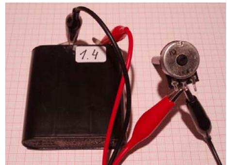
Abb.1.14: Schaltung zum Innenwiderstand von Elektrizitätsquellen
