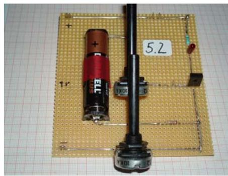
Abb.5.6: Schaltplatine zur Strom- und Spannungsverstärkung
