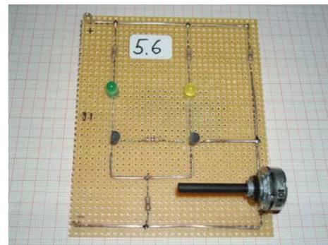
Abb.5.25: Schaltplatine zur Schmitt Trigger Schaltung
