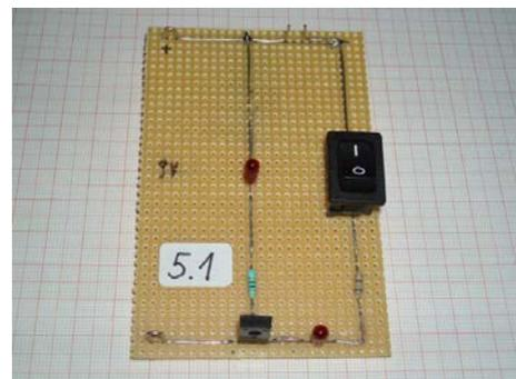
Abb.5.2: Schaltung zum Transistoreffekt
