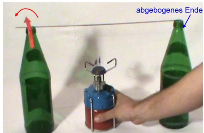
Abbildung 93: Wärmeausdehnung von Metall
