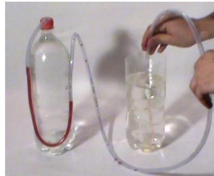
Abbildung 54: U-Rohr-Manometer
