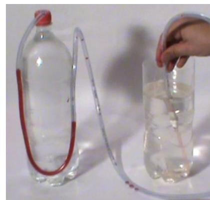
Abbildung 55: U-Rohr-Manometer
