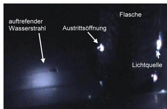
Abbildung 83: Wasserstrahl als Lichtleiter
