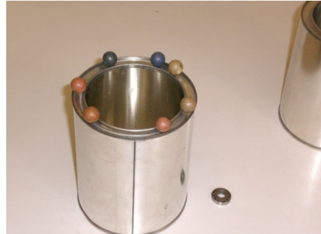
Abbildung 21: Modell eines Kugellagers
