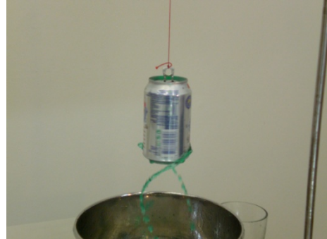
Abbildung 1: Das Senger'sche Wasserrad
