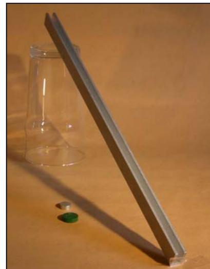
Bild 5-10: Der Magnet rollt durch Wirbelströme gebremst.
