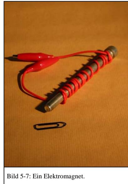
Bild 5-7: Ein Elektromagnet.
