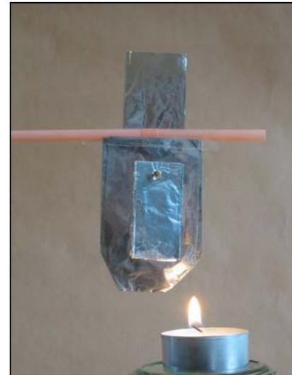
Bild 2-8: Durch Heranführen der Flamme wird das Elektroskop entladen.
