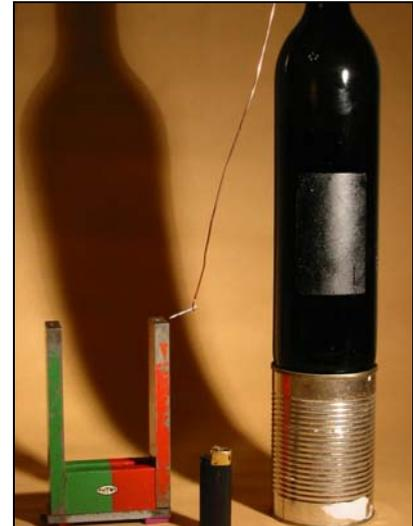
Bild 4-6: Mit der Curie-Temperatur verliert der Nagel seinen Magnetismus.
