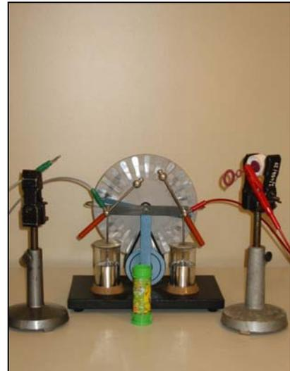
Bild 2-16: Die Seifenblasen fliegen entlang der Feldlinien.
