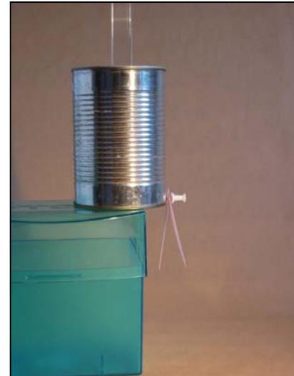
Bild 2-9: Durch Influenz schlägt das Elektroskop aus.
