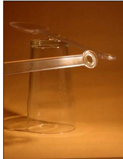
Bild 2-2: Die gleichnamig geladenen Löffel stoßen sich ab.
