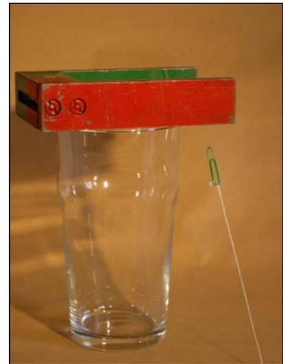
Bild 4-5: Die Büroklammer schwebt im Magnetfeld.
