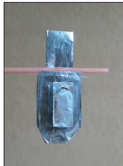
Bild 2-7: Ladungen können auf das Elektroskop übertragen werden.
