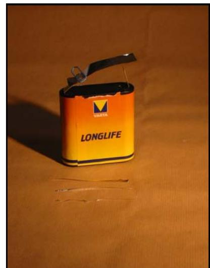
Bild 3-5: Fließt Strom durch die Folie so wird sie heiß.
