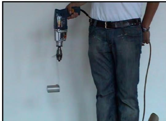
**Abb. 93** Das Rohrstück rotiert um die Achse mit größtem Trägheitsmoment
