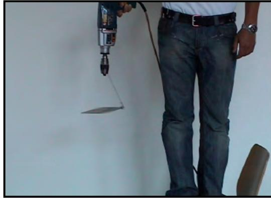
**Abb. 91** Das Quadrat dreht sich um die Achse mit maximalem Trägheitsmoment
