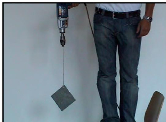
**Abb. 90** Das Quadrat dreht sich um die Achse mit minimalem Trägheitsmoment
