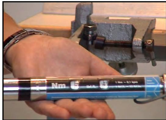
Abb. 9 Hier wird der Drehmomentwert eingestellt
