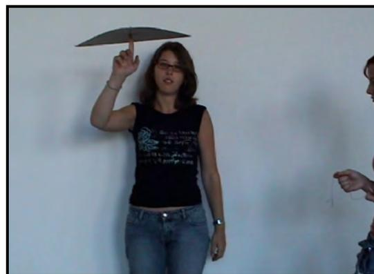
Abb. 14 Das Dreieck kann mit dem Finger am Schwerpunkt balanciert werden
