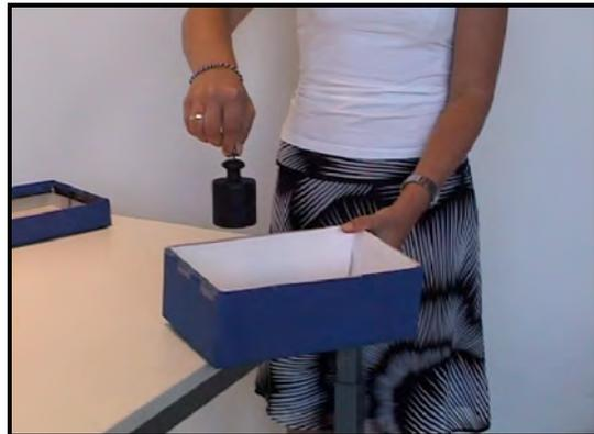
Abb. 33 Der Schwerpunkt der Schachtel wurde durch das Gewicht verlagert
