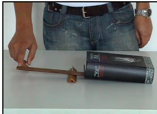
Abb. 11 Mit dem Hebel wird das Buch gehoben
