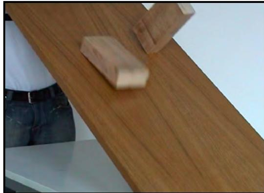
Abb. 29 Der Quader mit der längeren Seite an der Front fällt schneller um
