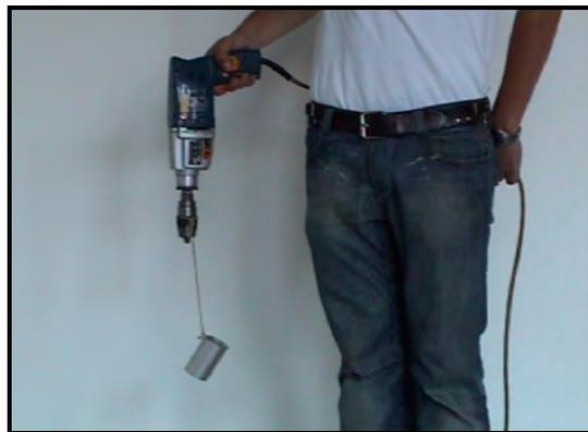
**Abb. 92** Das Rohrstück rotiert um die Achse mit kleinstem Trägheitsmoment
