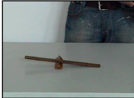
Abb. 10 Das Lineal als Hebel
