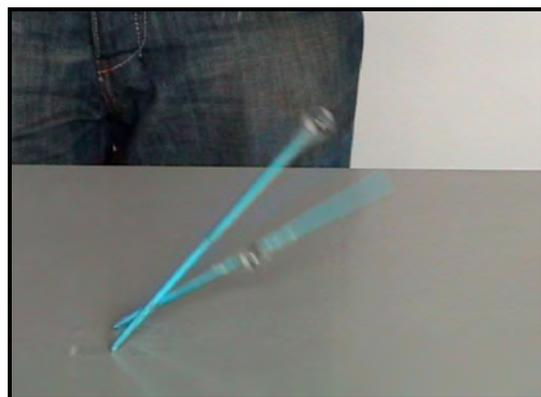
**Abb. 72** Der Stab mit der Murmel in der Mitte fällt schneller um
