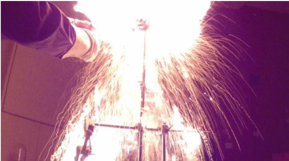
Abb. 49: Ausschnitt aus dem Go-Pro-Echtzeitvideo „Löschen eines Fettbrandes“
