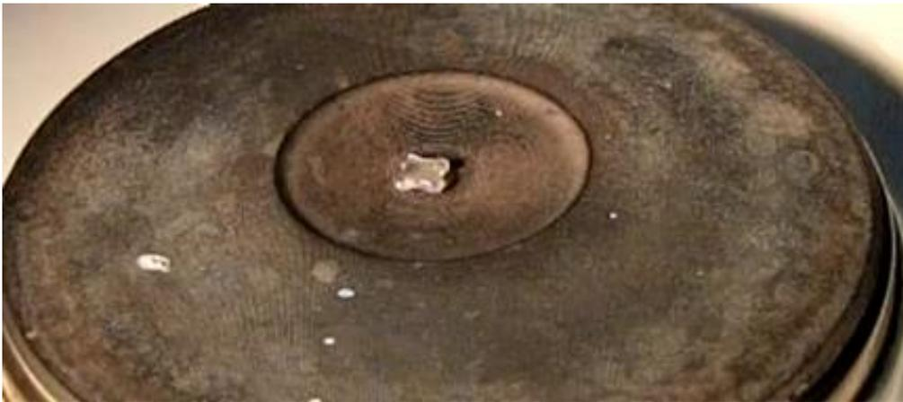
Abb. 46: Tropfen auf heißer Herdplatte. Aufgrund des „Schwebezustandes“ kann der Tropfen in seiner Form recht lange schwingen, da keine Reibung Energie entzieht.
