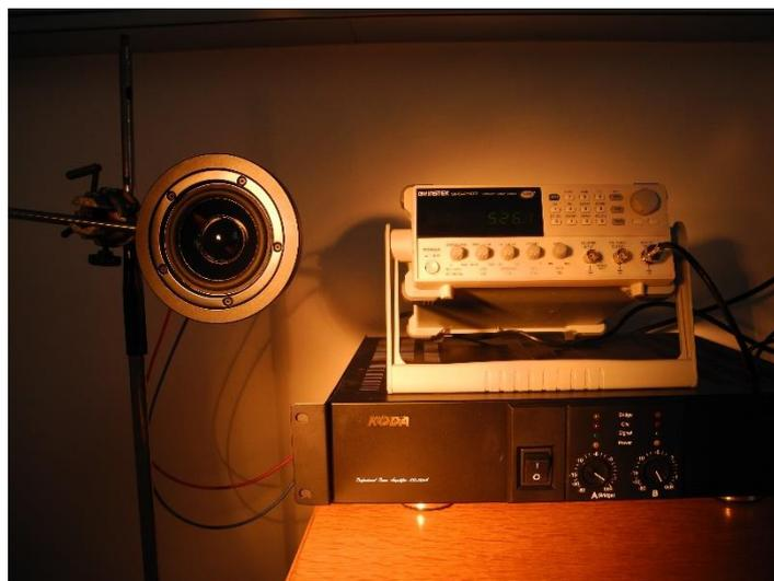
Abb. 85: Die zur Anregung verwendeten Geräte
