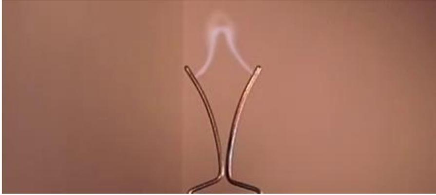
Abb. 70: Ausschnitt aus dem High-Speed-Video „Lichtbogenentladung“
