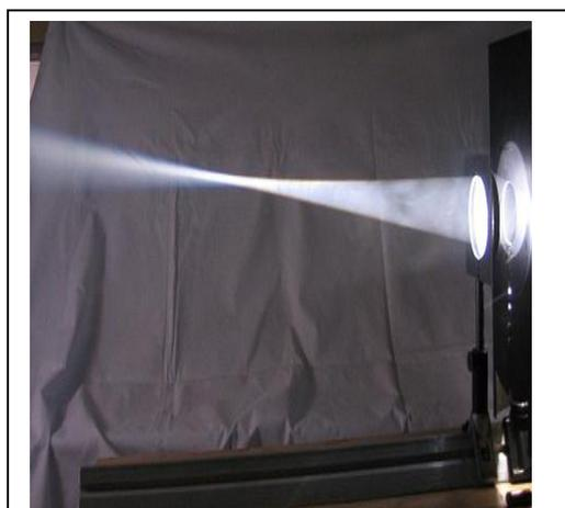
**Abb. 59** Das konvergente Lichtbündel nach dem Durchgang durch eine Sammellinse
