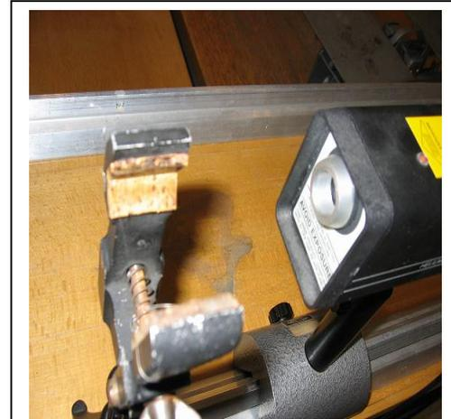
**Abb. 84** Ein dünner Draht wird in den Laserstrahl gehalten
