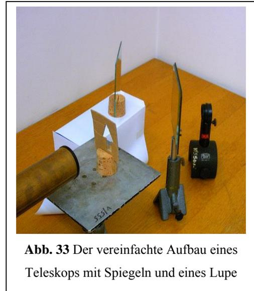
**Abb. 33** Der vereinfachte Aufbau eines Teleskops mit Spiegeln und einer Lupe
