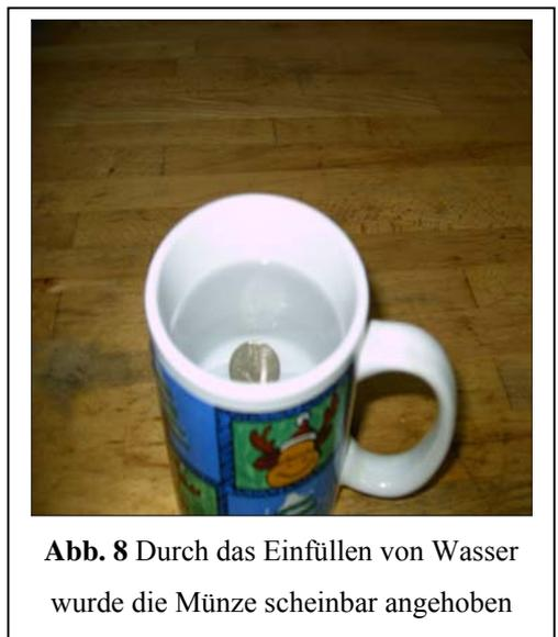
**Abb. 8** Durch das Einfüllen von Wasser wurde die Münze scheinbar angehoben
