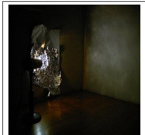
**Abb. 5** Diffuse Reflexion an der zerknitterten Folie
