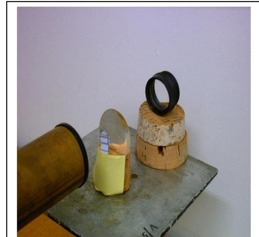
**Abb. 29** Der vereinfachte Aufbau eines Mikroskops mit 2 Linsen
