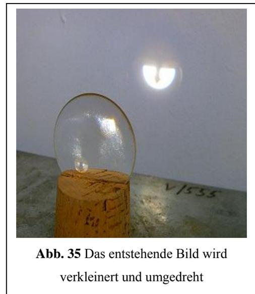
Abb. 35 Das entstehende Bild wird verkleinert und umgedreht
