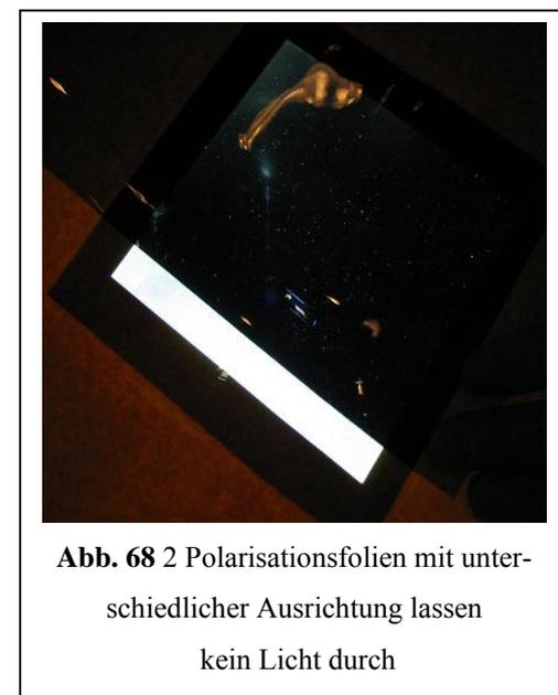
Abb. 68 2 Polarisationsfolien mit unterschiedlicher Ausrichtung lassen kein Licht durch
