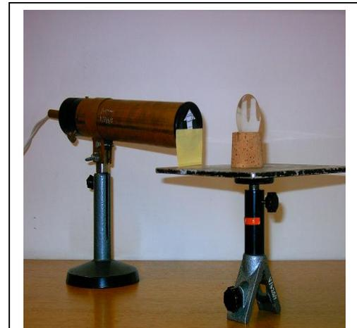
Abb. 34 Der Aufbau eines Fotoapparates
