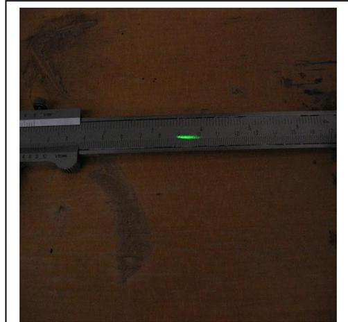
**Abb. 96** Der Laserstrahl muss schleifend auf die Skala der Schiebelehre auftreffen
