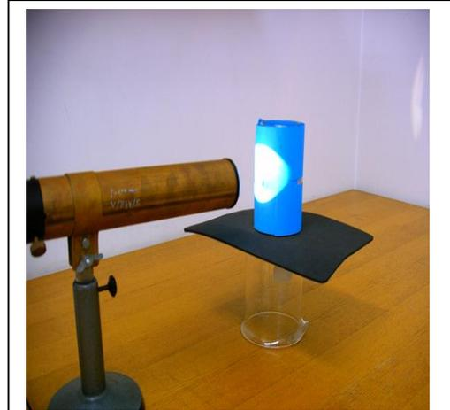
**Abb. 16** Versuchsaufbau um den Brechungsindex von Wasser zu berechnen
