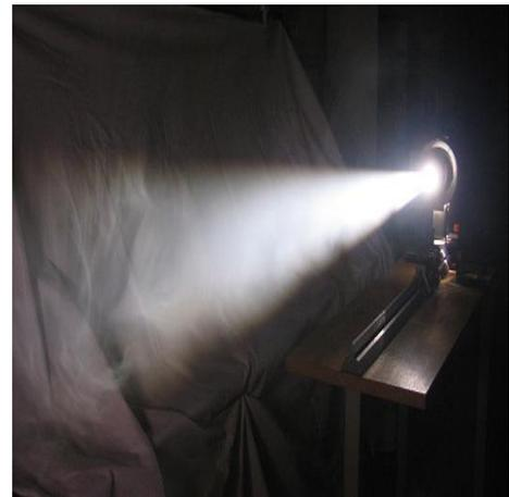
**Abb. 60** Das divergente Lichtbündel beim Durchgang durch eine Zerstreuungslinse
