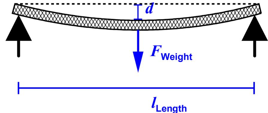
Aus den für die verschiedenen Belastungen (verschiedene Gewichtskräfte)  $F_{W_i}$  ermittelten Durchbiegungen  $d_i$  und den einmal ermittelten Werten für die Stützweite  $l_{\text{Length}}$  und die Querschnittsabmessungen  $l_{\text{Width}}$  und  $l_{\text{Height}}$  eines Balkens wird der Elastizitätsmodul ( $[E] = \text{N/m}^2$ ) mit der Gleichungen
