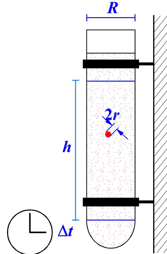
Aus der Geschwindigkeit  $v$ , dem Radius  $r$  und der Dichte  $\rho_{\text{Ball}}$  des Materials der Kugeln und der Dichte  $\rho_{\text{Fluid}}$  des Getriebeöls wird anschliessend die dynamische Viskosität mit der Formel von *Stokes*
