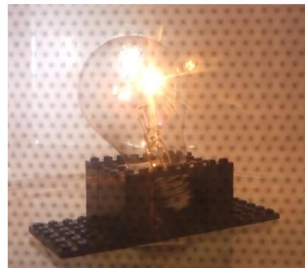
Abbildung 79: Glühlampe in der Mikrowelle, Glühfaden leuchtet hell auf; eigenes Bild
