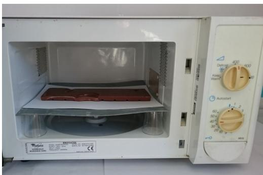
Abbildung 14: Lichtgeschwindigkeit ermitteln, Versuchsaufbau; eigenes Bild
