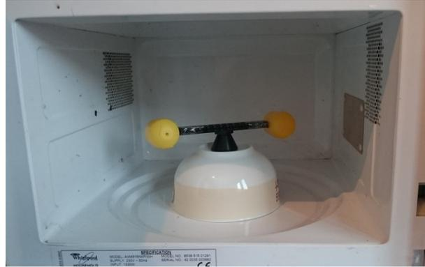
Abbildung 25: das Dampfkarussell wird zentral im Garraum platziert; eigenes Bild
