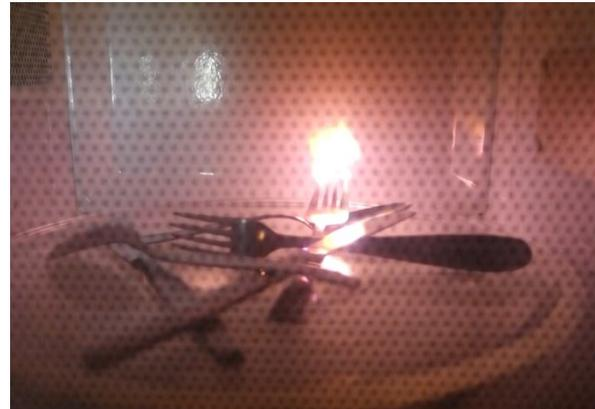
Abbildung 72: Essbesteck in der Mikrowelle, Entladung an der Gabelspitze; eigenes Bild
