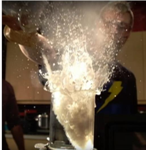
Abbildung 83: Siedeverzug von Wasser, gibt man Kondensationskeime in das überhitzte Wasser verdampft es explosionsartig; Quelle: YouTube/Time Warp
