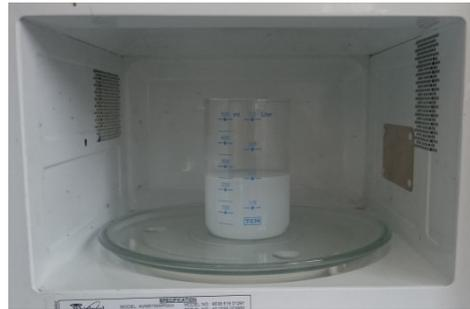
Abbildung 35: Glas mit 250 ml Salzwasser (2 Teelöffel Speisesalz) in der Mikrowelle; eigenes Bild
