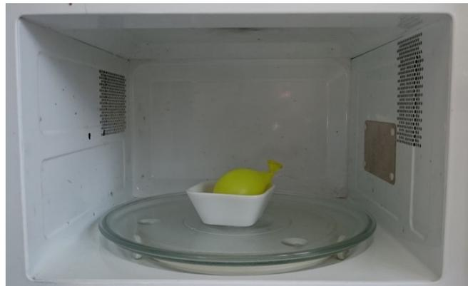
Abbildung 26: Luftballon mit Wasser in der Mikrowelle, Versuchsaufbau, die Schale haltet den Ballon auf Position; eigenes Bild
