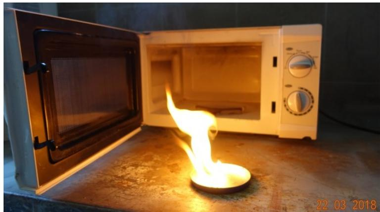
Abbildung 85: Metallschwamm im Benzinbad, das Feuer sollte unverzüglich mit einer Löschdecke gelöscht werden; eigenes Bild
