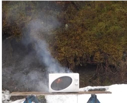
Abbildung 92: Farbsprühdosen in der Mikrowelle, die Kunststoffkappen der Dosen fangen Feuer; eigenes Bild
