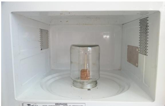
Abbildung 54: mittels Streichholz Plasma erzeugen, Versuchsaufbau; eigenes Bild
