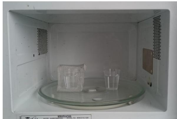
Abbildung 49: Faraday'scher Käfig in der Mikrowelle, Versuchsaufbau; eigenes Bild
