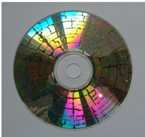
Abbildung 62: CD in Mikrowelle, zerstörte Aluminiumschicht nach Versuch; eigenes Bild
