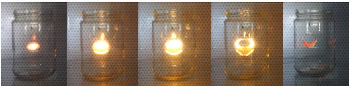
Abbildung 70: die zuvor erhitzte Stelle wird unter der Mikrowellenstrahlung weiter erhitzt und das Glas schmilzt; eigenes Bild
