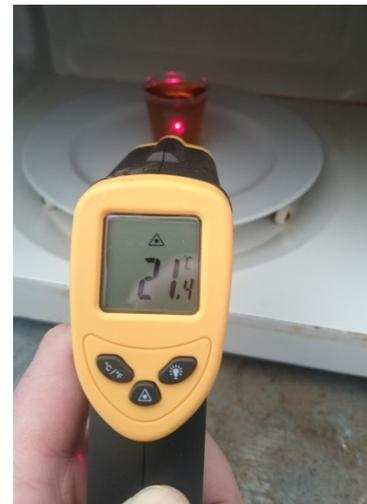
Abbildung 52: unpolare Flüssigkeit in der Mikrowelle, Temperaturmessung nach einer Minute MW Betrieb; eigenes Bild
