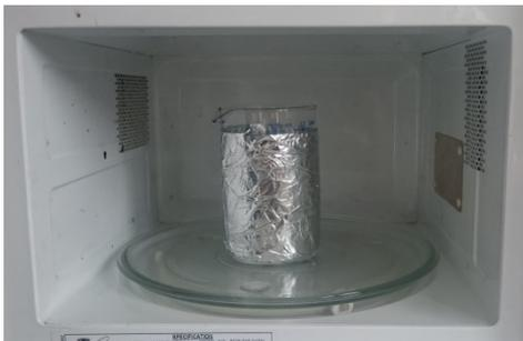
Abbildung 36: Glas mit 250 ml Wasser mit Aluminiumfolie umwickelt; eigenes Bild
