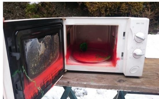
Abbildung 93: Farbsprühdosen in der Mikrowelle, die unter Druck stehenden Weißblechdosen explodieren; eigenes Bild
