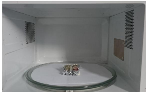
Abbildung 64: Chipstüte nach Anlegen eines elektromagnetischen Feldes, Chipstüte schrumpft; eigenes Bild
