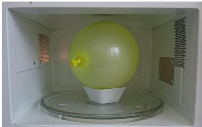
Abbildung 27: das enthaltene Wasser ist verdampft und das Volumen des Ballons hat sich vergrößert; eigenes Bild
