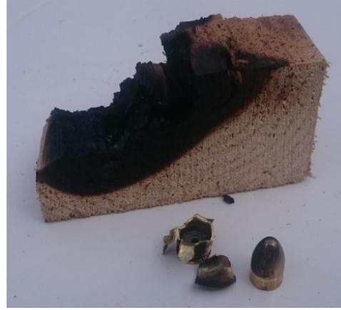
Abbildung 91: Überreste des Experiments, geborstene Messinghülse; eigenes Bild
