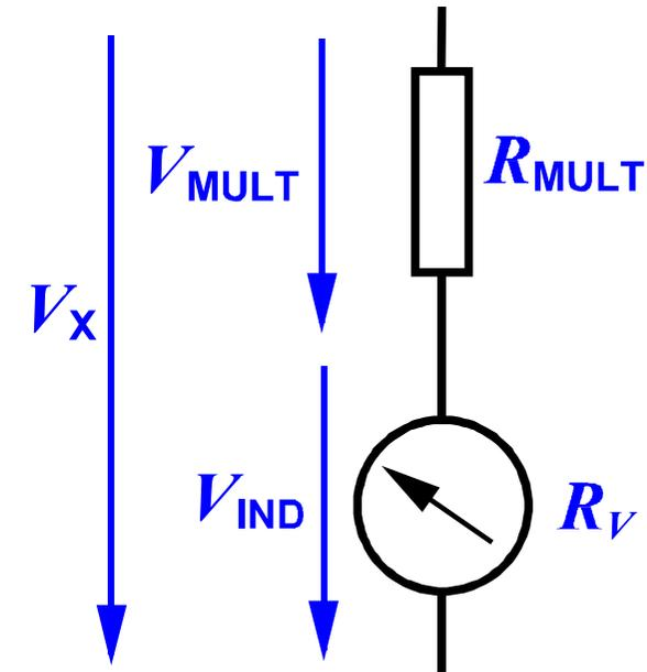
$$V_{IND} = \frac{R_V}{R_V + R_{MULT}} \cdot V_X \quad \Rightarrow \quad V_X = \left( 1 + \frac{R_{MULT}}{R_V} \right) \cdot V_{IND}$$
