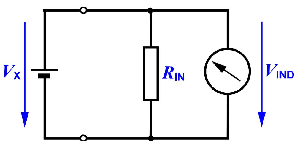
Schematischer Messaufbau einer Spannungsmessung.
