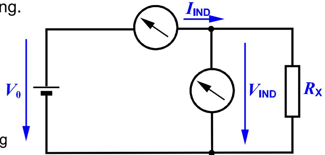
Schematischer Aufbau bei der Ermittlung einer Kennlinie nach der Methode der simultanen Strom-Spannung-Messung.
