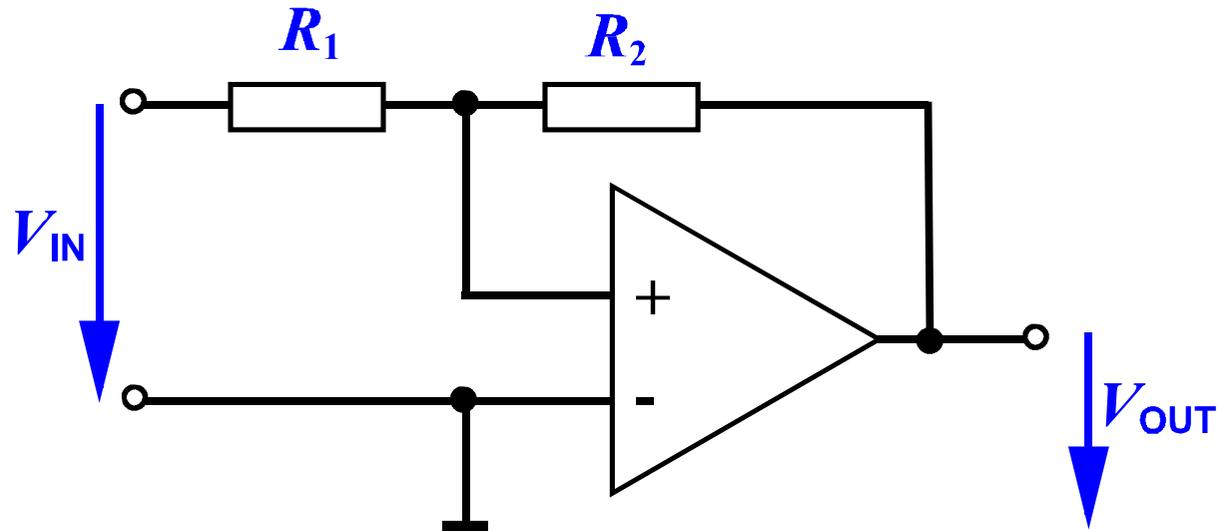
$$V_{\text{OUT}} \cong A \cdot V_{\text{IN}}$$
