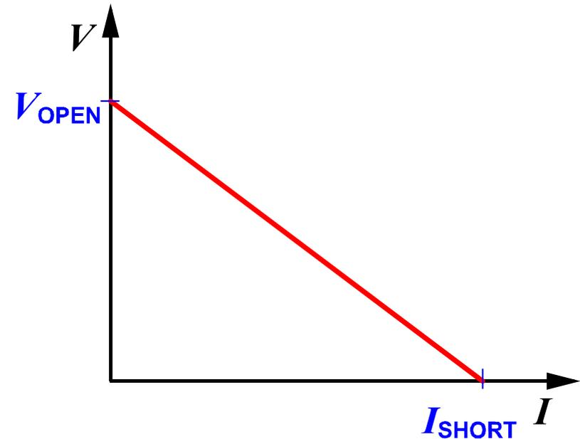
Klemmenspannung  $V$  einer Spannungsquelle über dem entnommenen Strom  $I$ .
