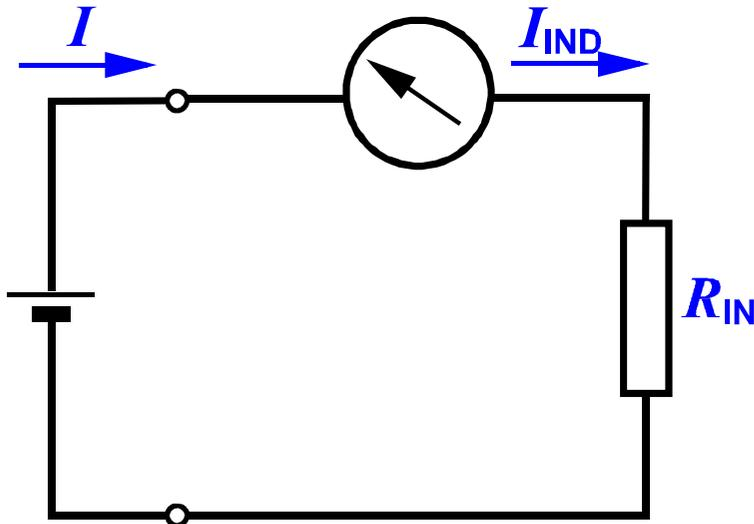
Schematischer Messaufbau einer Strommessung.
