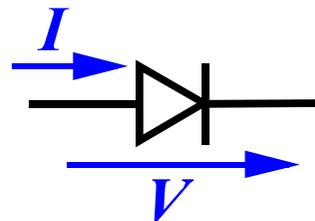
Strom  $I$  durch eine Diode über der an den Enden angelegte elektrische Spannung  $V$ .
