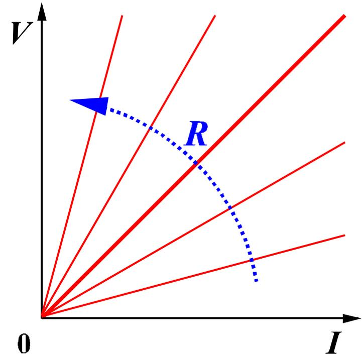
Allgemein hat ein Bauelement eine Spannung-Strom-Kennlinie (Spannung zwischen den Enden als eindeutige Funktion des eingespeisten Stromes)
