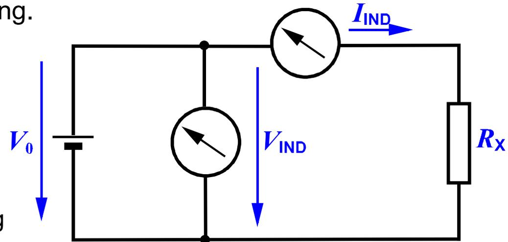
Schematischer Aufbau bei der Ermittlung einer Kennlinie nach der Methode der simultanen Spannung- Strom-Messung.
