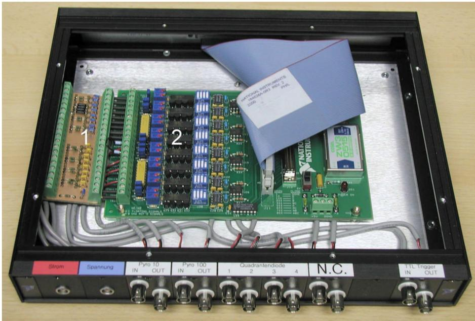
Abbildung 3.41: Messdatenaufbereitungseinheit. 1 anti-aliasing Filter, 2 sample-and-hold Stufe, im unteren Bereich sind die Anschlussbuchsen für die Messleitungen (v.l.n.r.: Strom, Spannung, Pyrometer, Vier-Quadranten Detektor) und die Triggerleitung (ganz rechts) zu erkennen.
