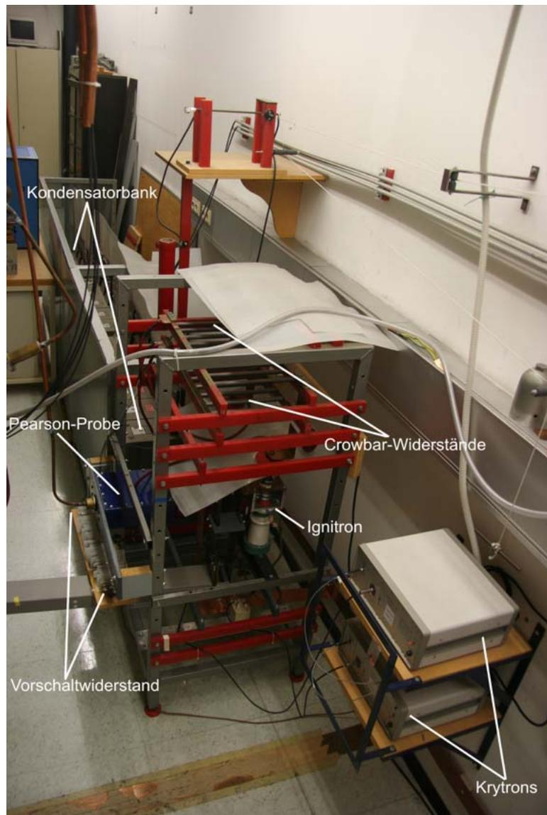
**Abbildung 3.4: Energieversorgung des Pulsheizexperiments.**
