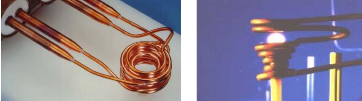
**Abbildung 3: Spulenanordnung für elektromagnetische Levitation.**
