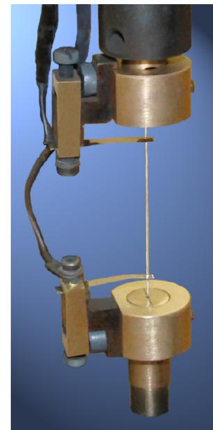
Abbildung 2: Eingespannte Drahtprobe. Aus [1, S.13].
