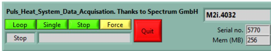
Abbildung 10: Loop: fortlaufende Darstellung der Messwerte. Single: einzelne Aufnahme von 4096 Datensätzen.
