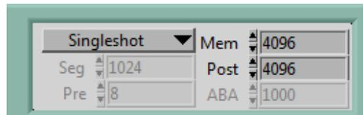
Abbildung 6: Aufnahmemodus. Der Modus Singleshot entspricht den Anforderungen im Normalbetrieb der Pulsheizanlage. Mem bezeichnet die Anzahl der Messpunkte.
