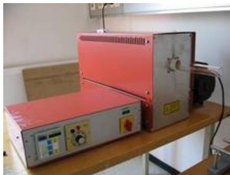
Abbildung 3-1 Rohröfen mit Quarzglasrohr
