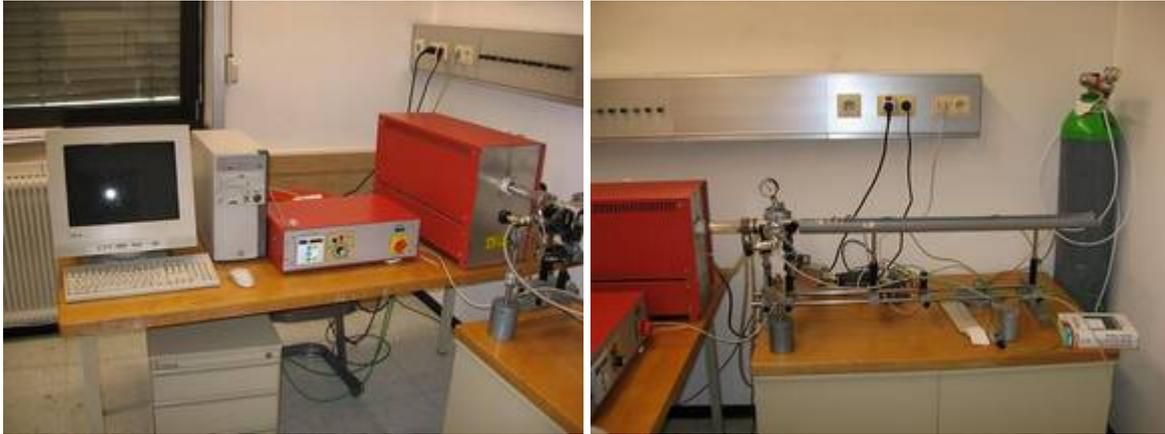
*Abbildung 3-18 Messanlage für die Vier-Punkt-Methode*
