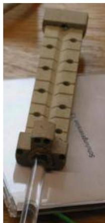
Abbildung 3-14 Messschiff mit Führungsplatten und Quarzstab
