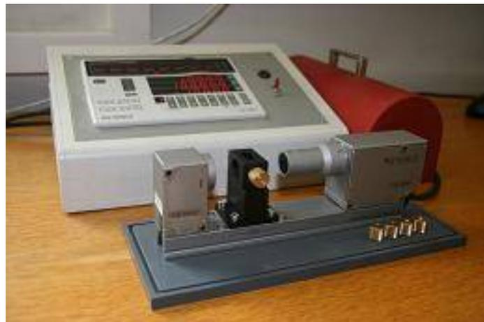
Abbildung 3-5 Lasermikrometer
