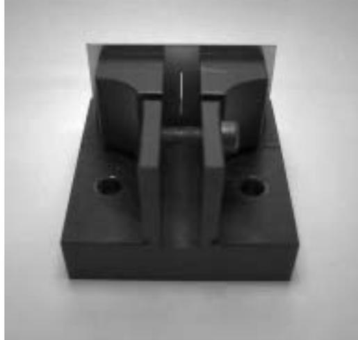
Abbildung 6: Blendenhalter mit der Aufnahme für den Lichtleiter und dem Spalt (Aufnahme von der Rückseite). Die Spaltblende ist von vorne auf den Halter geschraubt.
