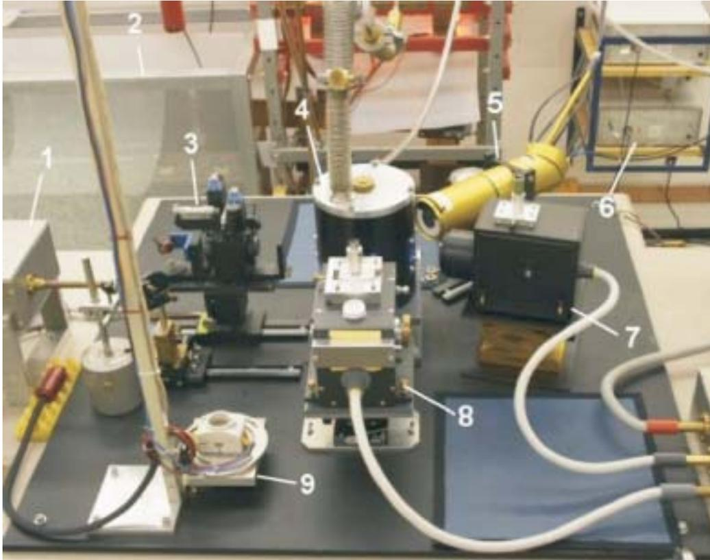
Abbildung 3: Versuchsaufbau in Graz. 1, 3, 5: Teile des DOAPs, 2: Kondensatorbank hinter Abschirmung, 4: Probenkammer, 6: Zündeinheiten für das Pulsheizexperiment, 7: 902 nm Pyrometer, 8: 650 nm Pyrometer, 9: Fassung für Wolframbandlampe.
