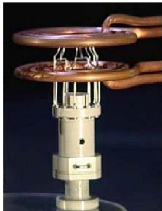
Abbildung 3: RF Coil System auf der ISS mit Wolfram Käfig und flacher Spulenausführung [7]
