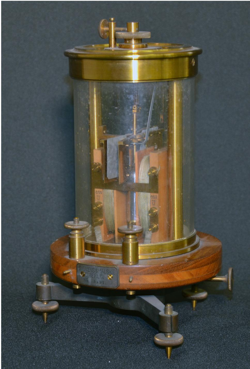
Abbildung 47: Bild des Torsionsgalvanometers
