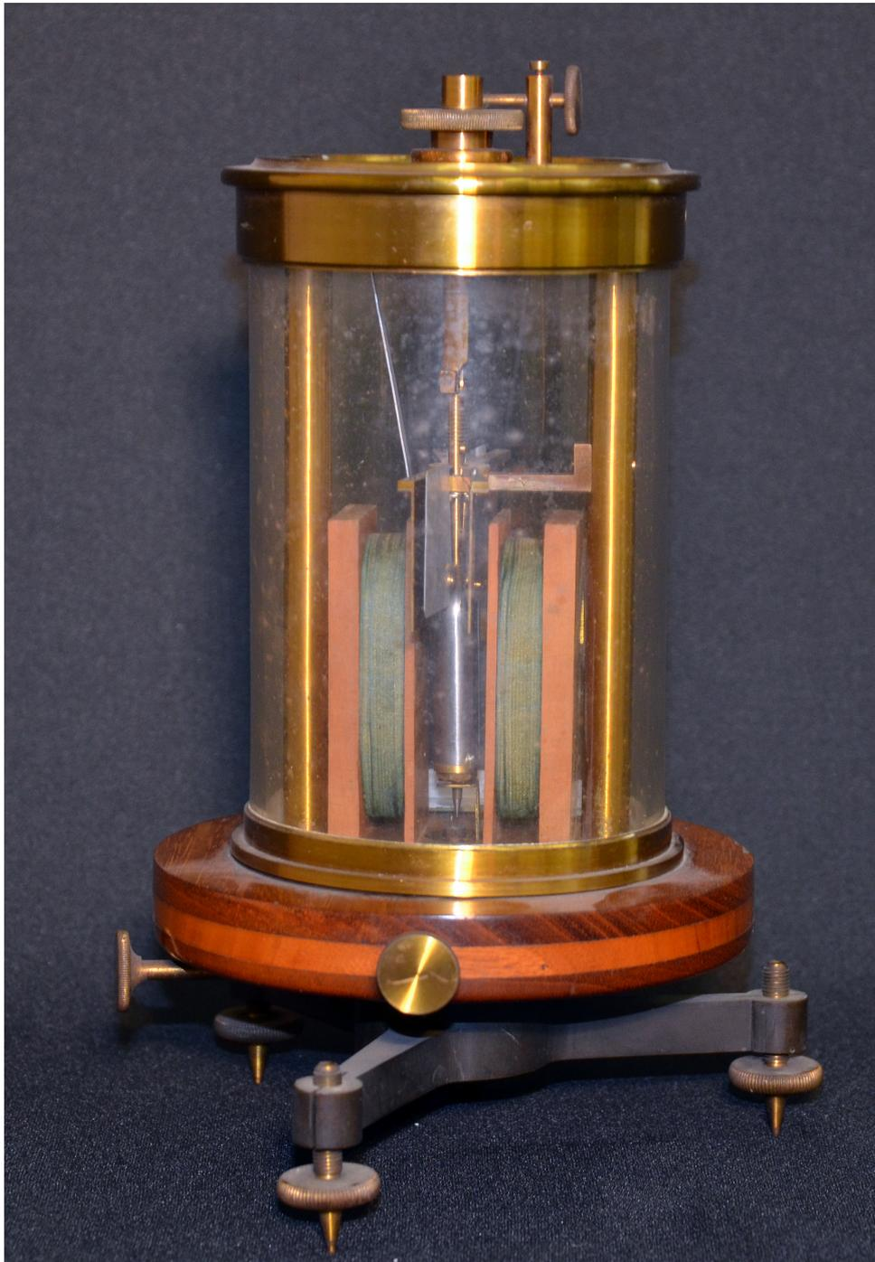
Abbildung 48: Bild des Torsionsgalvanometers
