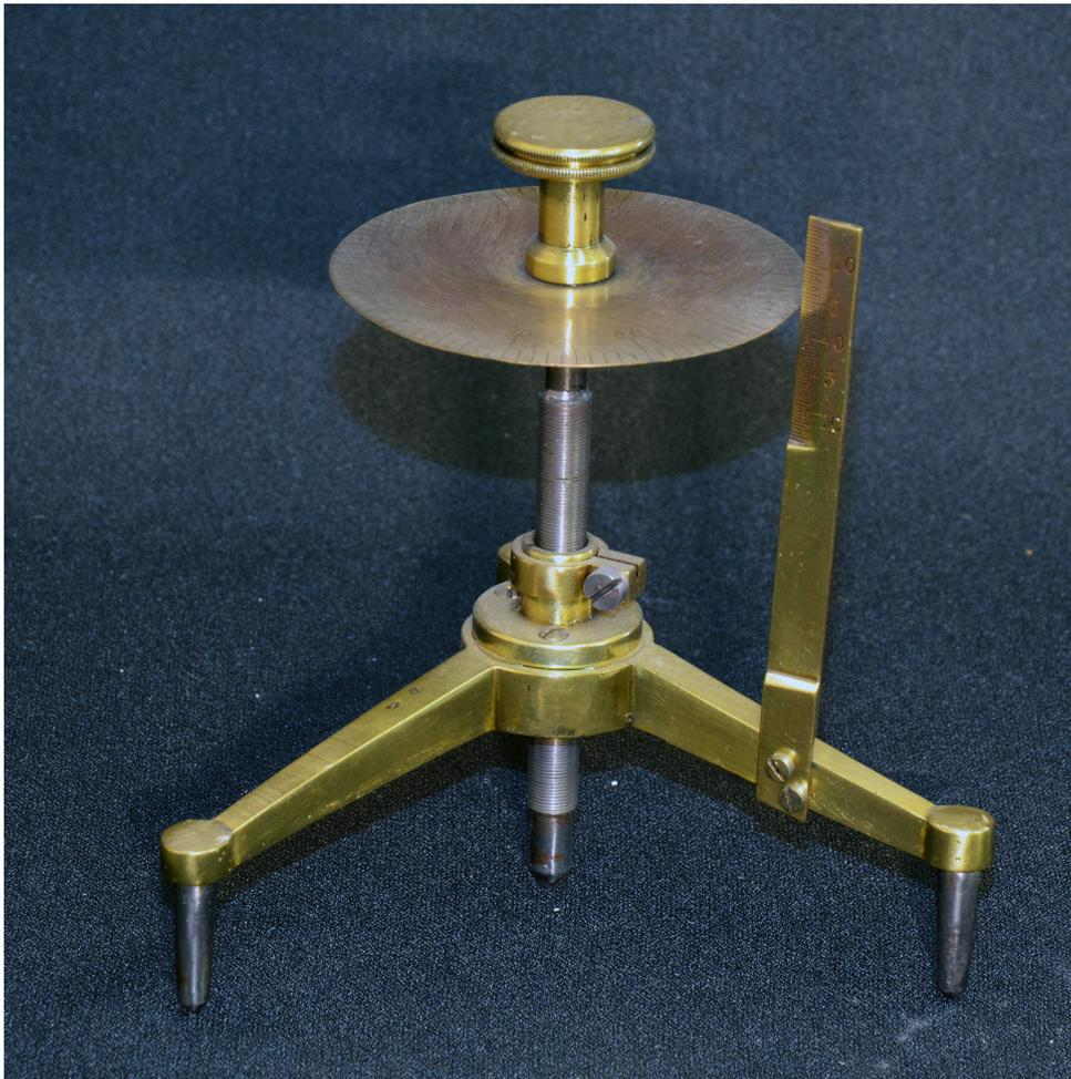
Abbildung 34: Foto des Sphaerometers von schräg oben
