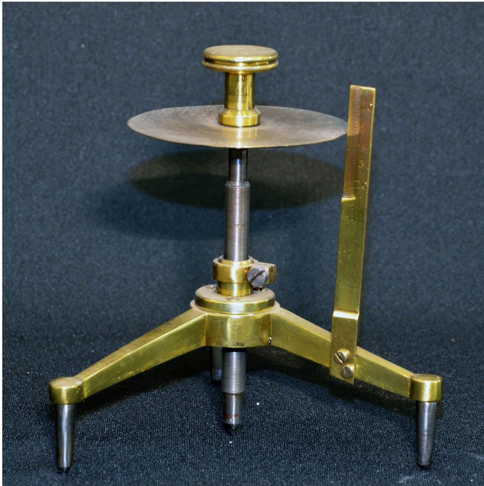
Abbildung 35: Foto des Sphärometers von schräg vorne
