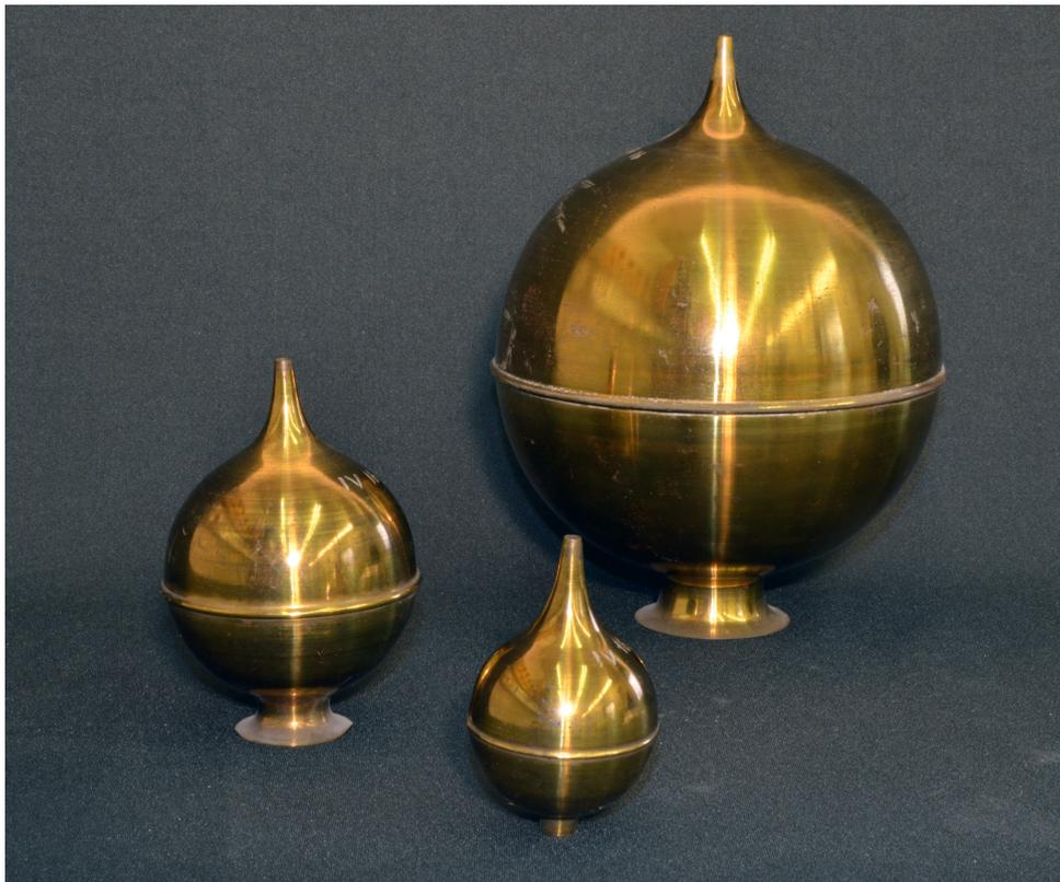
Abbildung 39: Bild von drei Resonatoren nach Helmholtz
