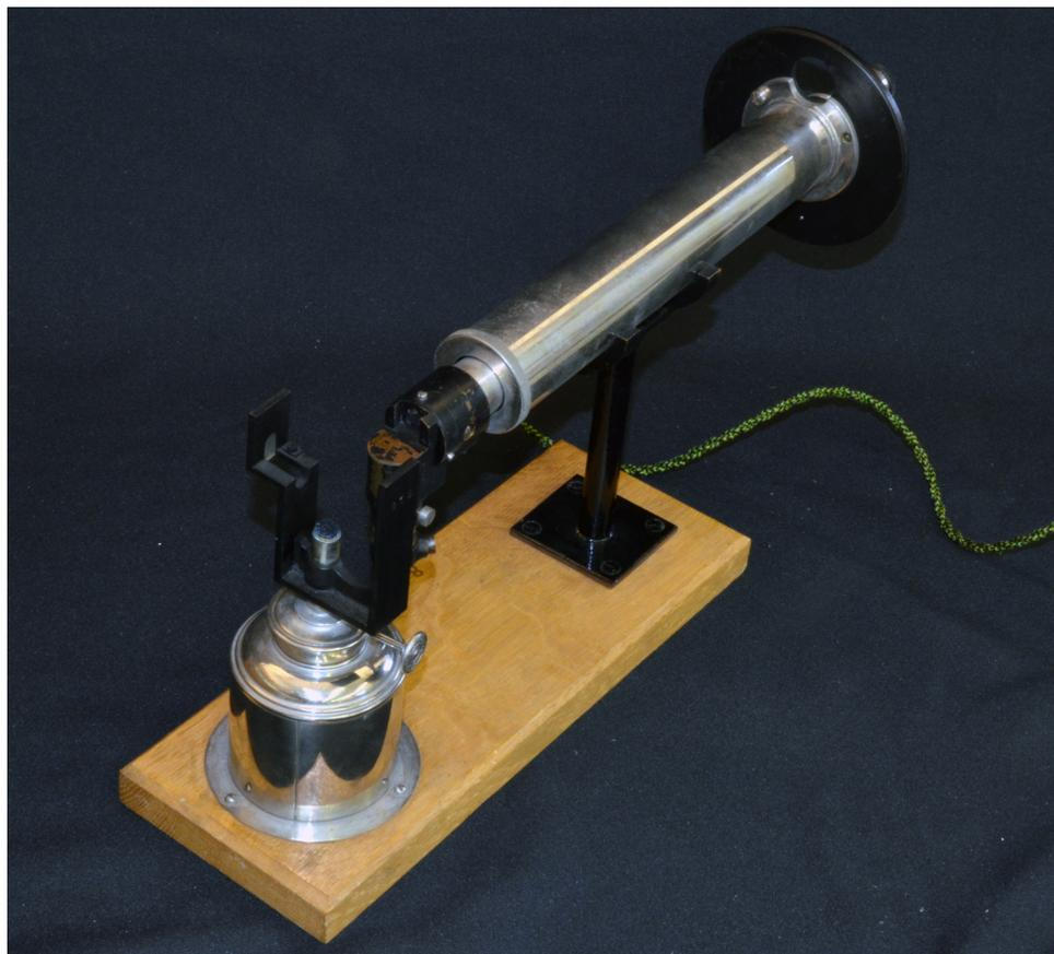
Abbildung 29: Bild des Pyrometers auf der Halterung mit Hefnerkerze
