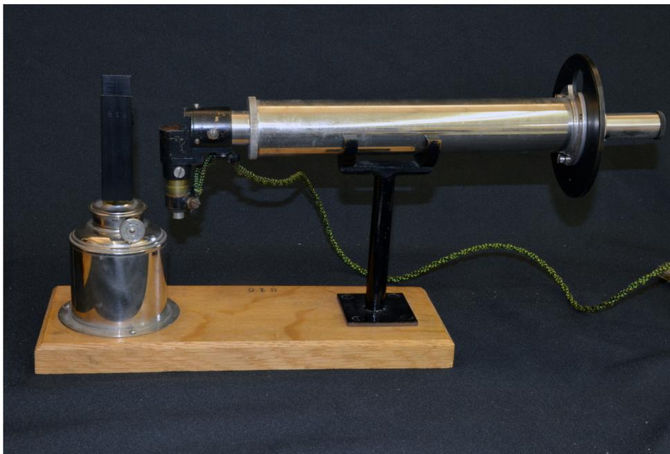
Abbildung 28: Bild des Pyrometers auf der Halterung mit Hefnerkerze
