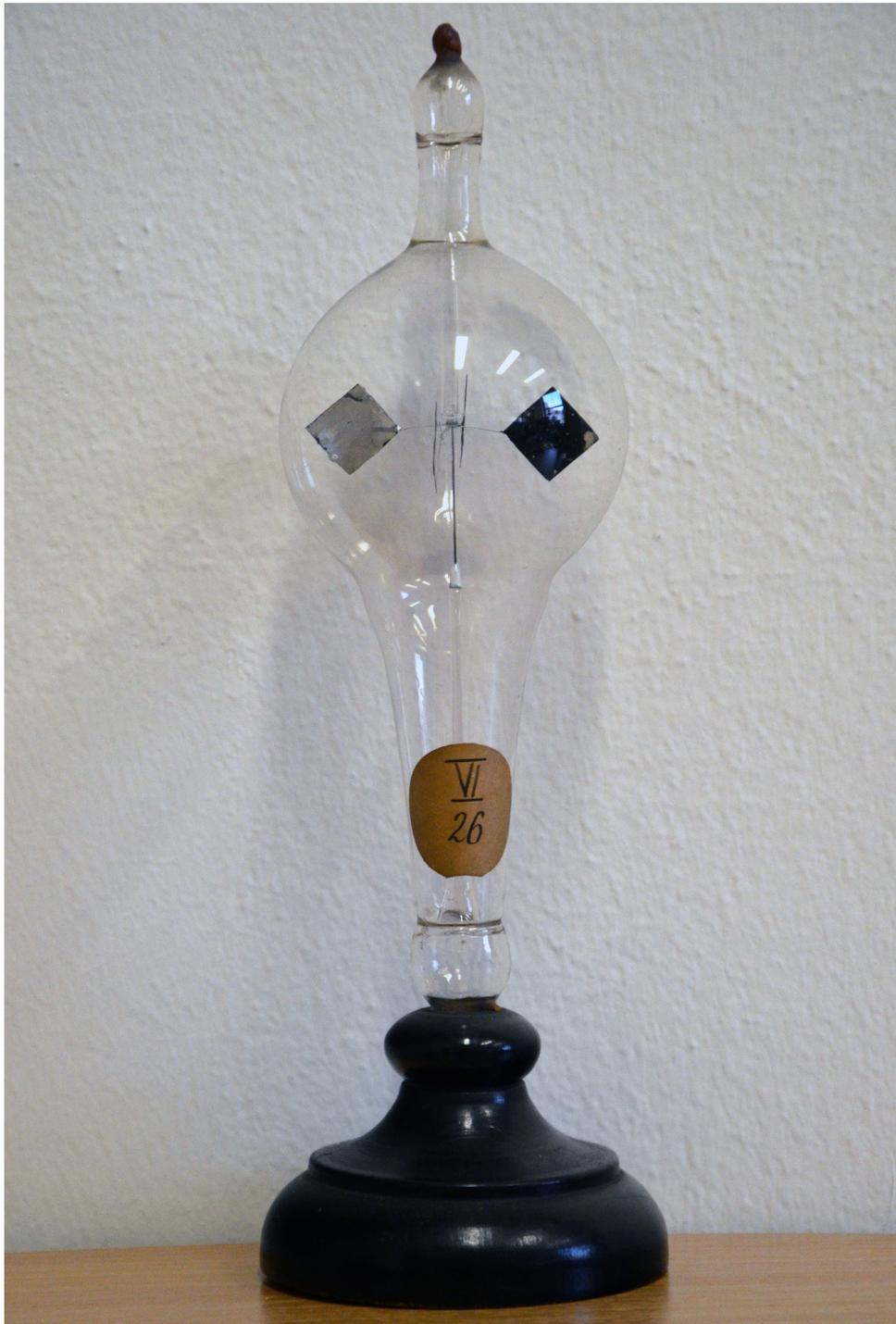
Abbildung 20: Bild der unechten Lichtmühle
