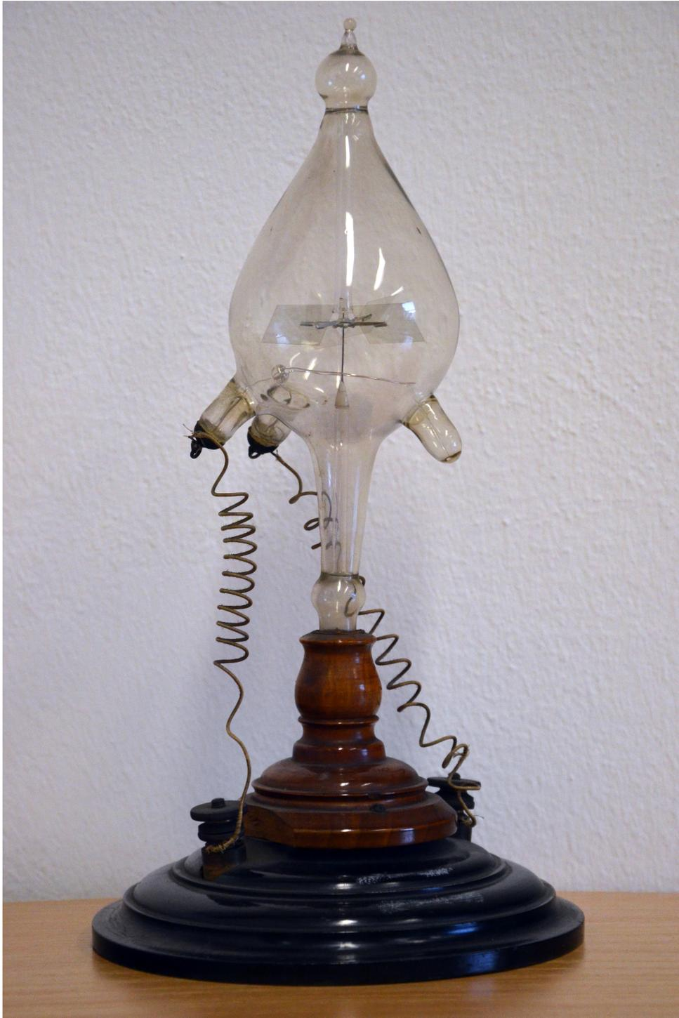
Abbildung 24: Bild der Konvektionsmühle
