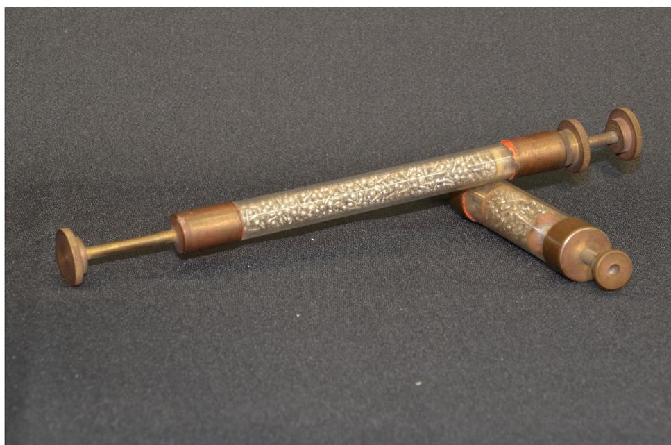
Abbildung 57: Bild der beiden ausgestellten Fritter/Kohärer des Institutes der Experimentalphysik
