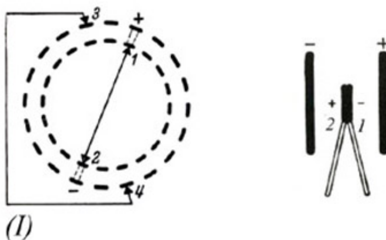
Abbildung 54: Schematische Darstellung der Wimshurst Influenzmaschine
