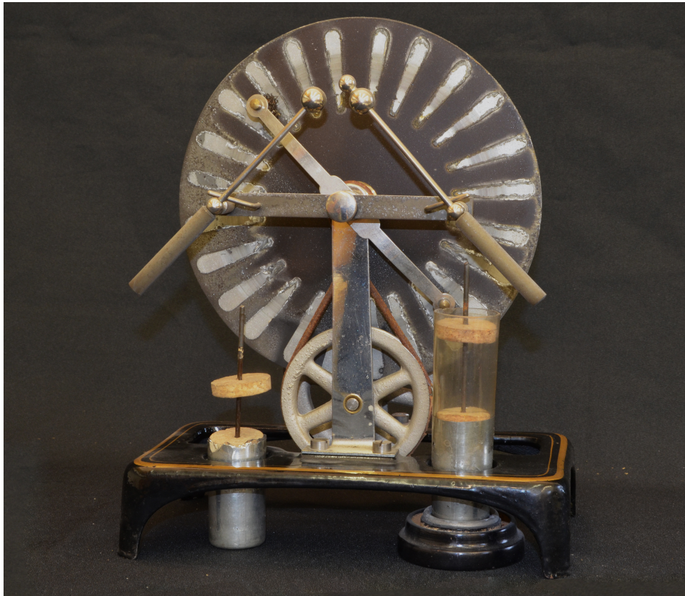
Abbildung 56: Ansicht der Influenzmaschine
