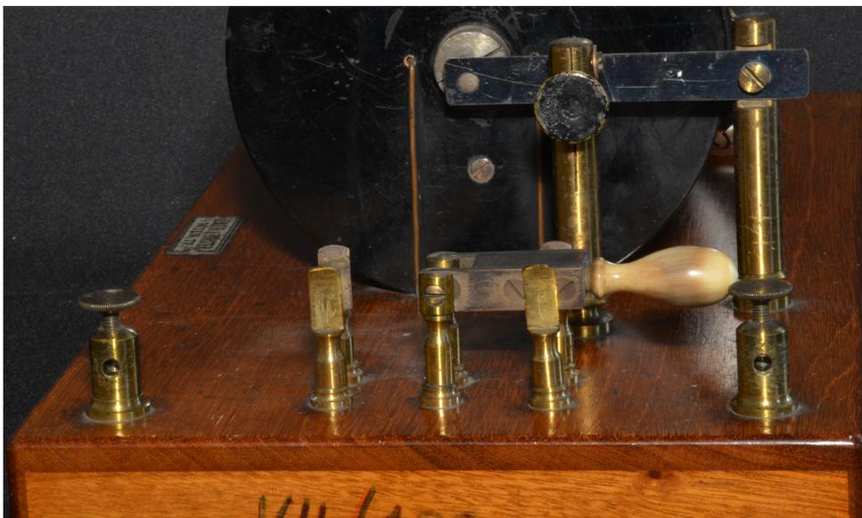
Abbildung 52: Nahaufnahme des Wagnerschen Hammers
