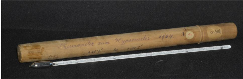
Abbildung 31: Thermometer zum Hypsometer
