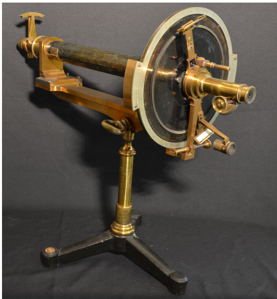
Abbildung 13: Bild des gesamten Halbschattenpolarimeters Gut sichtbar ist das Fernrohr des Polarimeters und die Winkelscheibe des Analysators.
