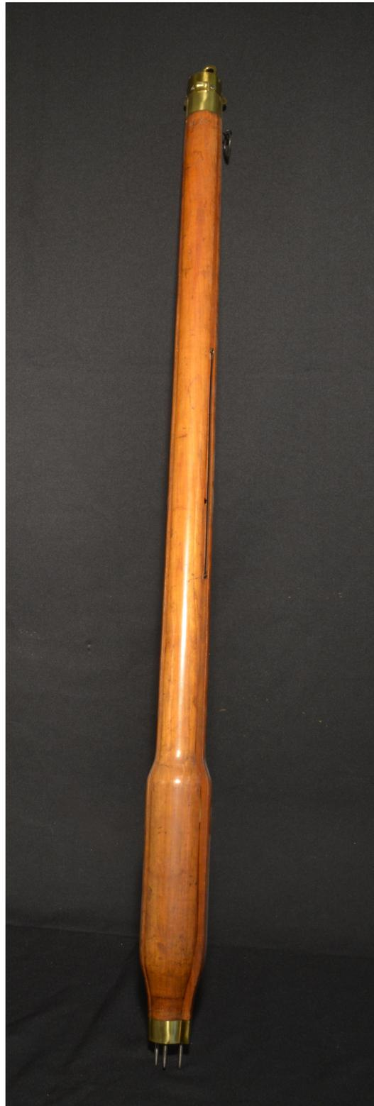
Abbildung 73: Bild des gesamten Reisebarometers, zusammengeklappt.
