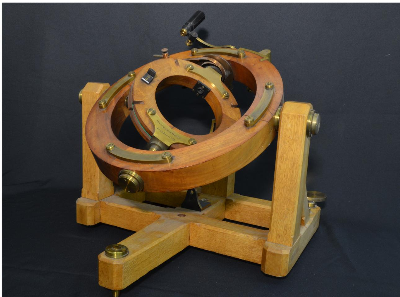
Abbildung 42: Gesamtaufnahme des Erdinduktors
