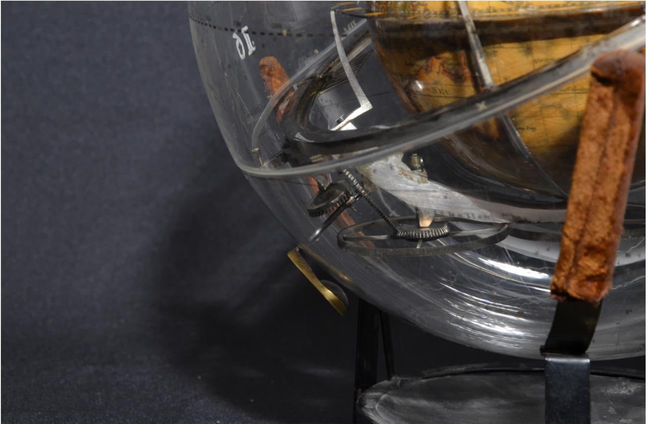
Abbildung 70: Bild der Feinmechanik des Chronoglobiums, links ist die Handkurbel, welche mit einem Finger bedient wird zu sehen, im Inneren der Glaskugel befinden sich verschiedene Zahnräder, welche für die richtige Geschwindigkeiten der einzelnen Bauteile benötigt werden.
