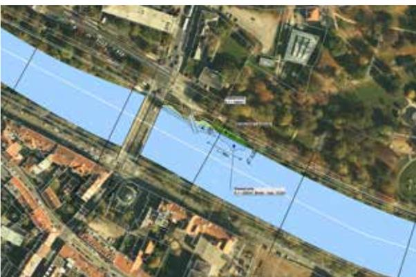
Flussauf und flussab der Grazbachmündung wird eine ca. 400 m<sup>2</sup> große Seichtwasserzone geschaffen und mit Totholz, Steinen etc. strukturiert. Der vorhandene gepflasterte Absturz wird entfernt und die Mündung sohlgleich an die Mur angebunden. In der Wasser-Land-Interaktionszone wird ein einreihiger Buschweidensaum gepflanzt, der funktional einer Buschweidenau entspricht.
