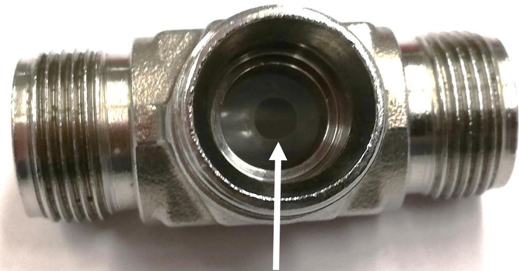
Damit die Referenzelektrode Kontakt zur Zelle hat muss die Öffnung in der Mitte sein
