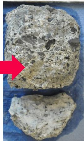
Extreme Schäden an einer Betonprobe in nur 1 Jahr durch Thaumasit
