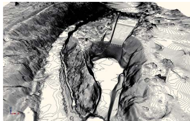
Falschfarben Höhenmodell und topographische Karte des Rico-bayo Staudammes und dessen Entlastungsgerinnes, Zamora, Spanien.
