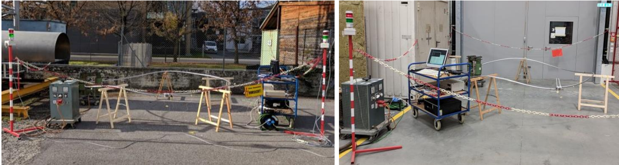
Bild 3: Orientierende IR-Messungen im Freifeld (li.) und im Labor (re.)
