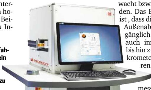
Beim Laser-Ultraschall-Verfahren wird durch einen sehr fein fokussierten, ultrakurzen Laserpuls eine hochfrequente Ultraschallwelle im zu prüfenden Material erzeugt
