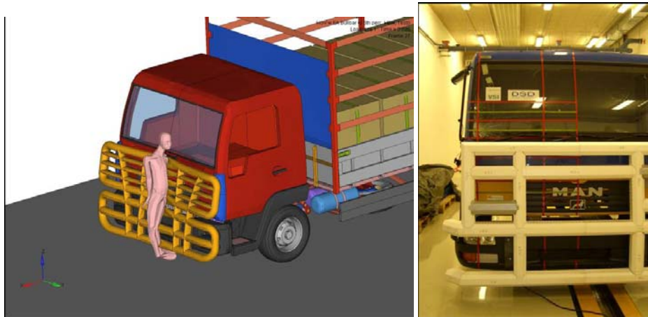
Abbildung 1: Nachrüstbare Schutzsysteme zur Erhöhung der Sicherheit ungeschützter Verkehrsteilnehmer
