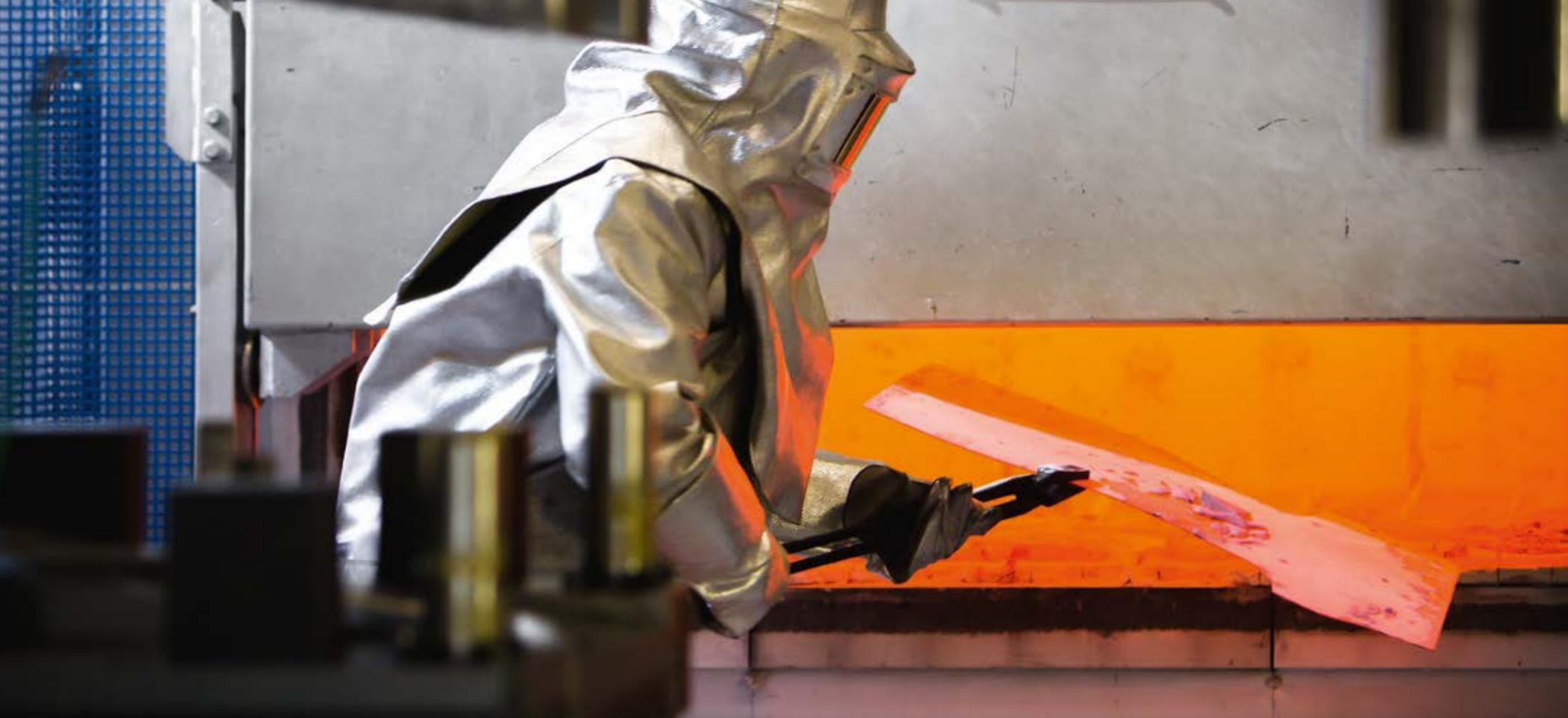
**Extreme Hitze:** 950 Grad beträgt die Temperatur der Stahlbleche bei der Umformung.
