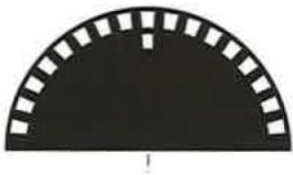
Bild 3.119 Impulsscheibe für Inkremental-Drehgeber
