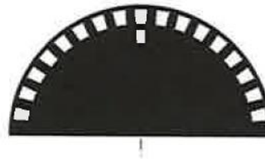
Bild 3.119 Impulsscheibe für Inkremental-Drehgeber
