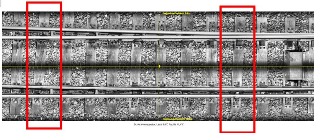
*Insbesondere in Weichen können verdrehte Schwellen relativ häufig gefunden werden. Wodurch Verdrehungen entstehen ist nicht bekannt, ebenso wenig die Auswirkungen auf die Lastabtragung und das Qualitätsverhalten des Fahrwegs. Diese Arbeit greift diese Fragestellungen auf und untersucht typische Spots an denen Schwellenverdrehungen auftreten und bewertet den Einfluss auf die Gleislageentwicklung. Für die Bearbeitung wird eine 25-jährige Zeitreihe an ÖBB-Messzugdaten bereitgestellt.*
