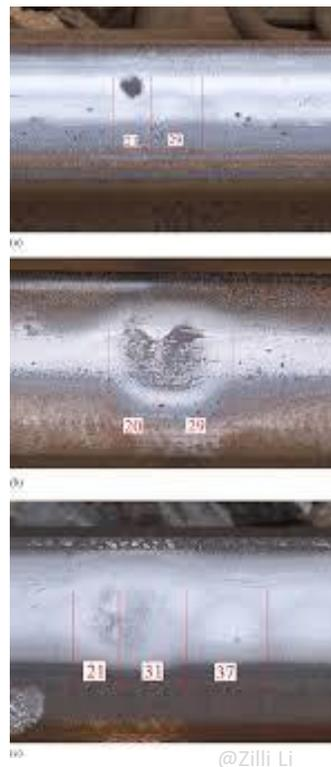
*Squats stellen viele Infrastrukturbetreiber vor große Probleme. Auch in Österreich scheint das Problem immer relevanter zu werden. Wenn zu spät detektiert müssen Schienen zufolge von Squats gewechselt werden. Durch eine frühzeitige Detektion lassen sie sich durch Schienenschleifen beseitigen. Das von ÖBB Messzügen erhobene Schienenoberflächensignal ist möglicherweise dafür geeignet. Dies muss jedoch erst bewiesen werden.*
