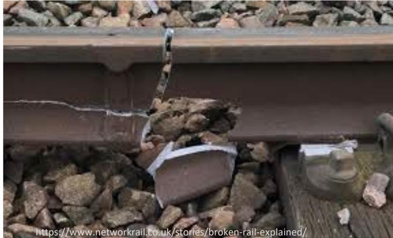
*Schienenbrüche treten verhältnismäßig häufig an Schweißstößen auf. Laut Literatur kann die Verwendung von Abbrennstumpfschweißungen anstelle von Thermitschweißungen Brüche deutlich reduzieren. Diese Arbeit soll diesen Zusammenhang datenseitig belegen. Dafür werden die Schienenbrüche der letzten Jahre im Netz der ÖBB analysiert und jeweils einer der beiden Schweißstößen zugeordnet. Für die Bearbeitung wird eine entsprechende Liste an Brüchen sowie weitere Inputdaten bereitgestellt.*
