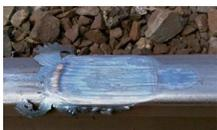
Der Einfluss der Traktionsenergie auf Schienenfehler
