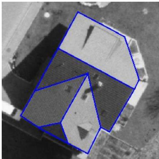
Abbildung 5.10: Ergebnis einer automatischen Gebäuderekonstruktion (Quelle: [Sha00])
