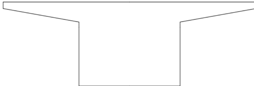
Abbildung 1 Querschnitt an der Maximalmomentenstelle, die Höhe beträgt 5cm
