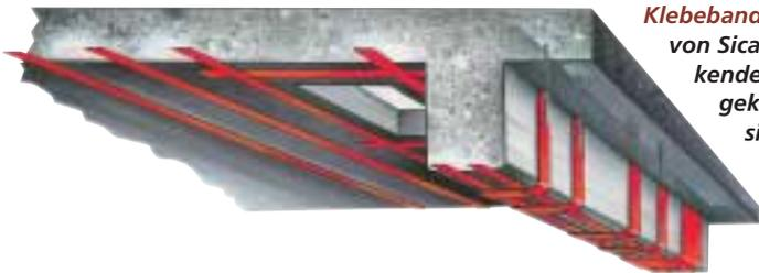
**Klebeband:** Die CarboDur-Lamellen von Sika, die auf die zu verstärkende Betonkonstruktion aufgeklebt werden, zeichnen sich durch ihre extreme Zugfestigkeit aus - 2800 N/mm<sup>2</sup> gegenüber 235 N/mm<sup>2</sup> von Stahl.
