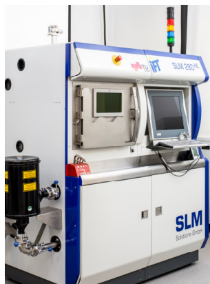
Selektive Laserschmelzanlage (smartfactory@tugraz)
