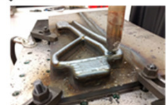
Drahtbasierter 3D-Druck mittels CMT-Verfahren
