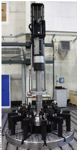
Rissfortschrittsuntersuchung an einer Radsatzwelle
