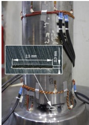
Rissfortschrittsuntersuchung an einer Radsatzwelle
