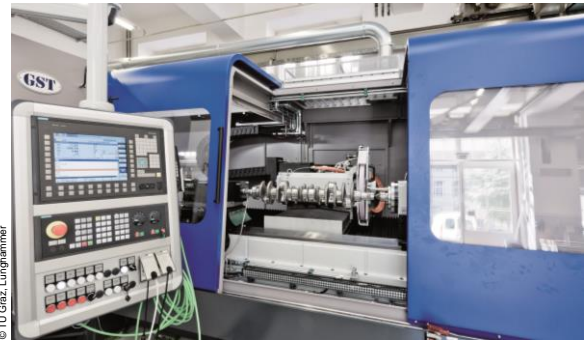
CNC-Forschungsschleifmaschine – weltweit einzigartige Spitzentechnologie für 3D-Unrund-Geometrien (ProLab)
