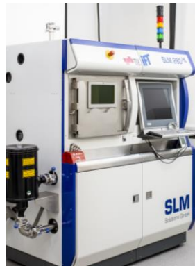
Selektive Laserschmelzanlage (smartfactory@tugraz)
