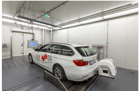
Emissionsuntersuchungen am Rollenprüfstand und mit OnBoard Messtechnik
