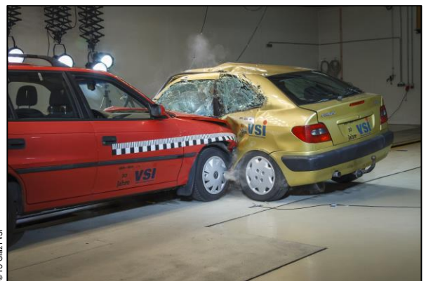
Crashtest im Rahmen einer Laborübung
